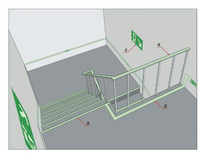
а - обозначение переднего горизонтального края ступеней фотолюминесцентными полосами; б - обозначение геометрии и края лестничной площадки фотолюминесцентной напольной направляющей линией; е - обозначение перил лестницы фотолюминесцентной полосой; г - комбинированный указатель направления эвакуации
