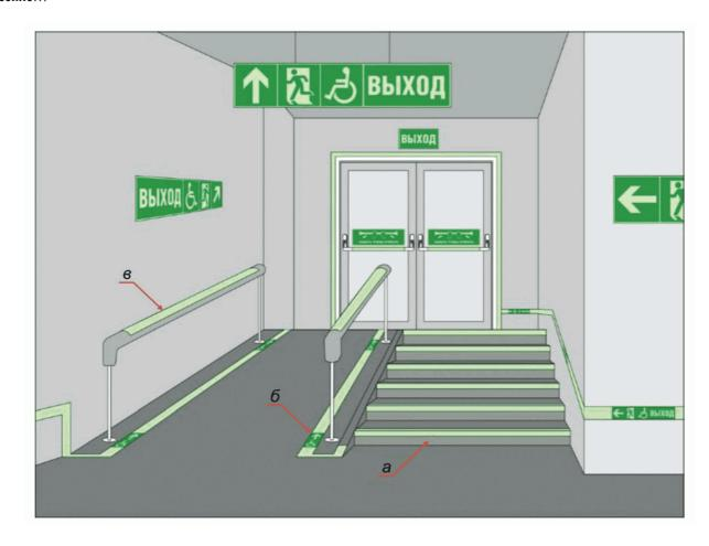
а - обозначение переднего горизонтального и вертикального краев ступеней фотолюминесцентными полосами; б - обозначение краев пандуса фотолюминесцентной напольной направляющей линией с включенным в ее состав указателем направления эвакуации; в - обозначение перил пандуса фотолюминесцентной полосой
