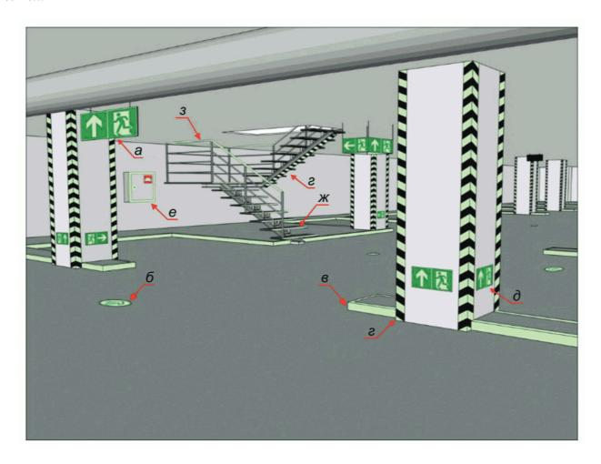
а - подвесной комбинированный указатель направления эвакуации; б - напольный указатель направления эвакуации; в - обозначение препятствий (перепадов пола); г - обозначение опасной зоны или конструкции здания, которая может стать причиной травмы; д - низко расположенный указатель направления эвакуации; е - обозначение места размещения пожарного оборудования; ж, з - обозначение ступеней и перил лестниц
