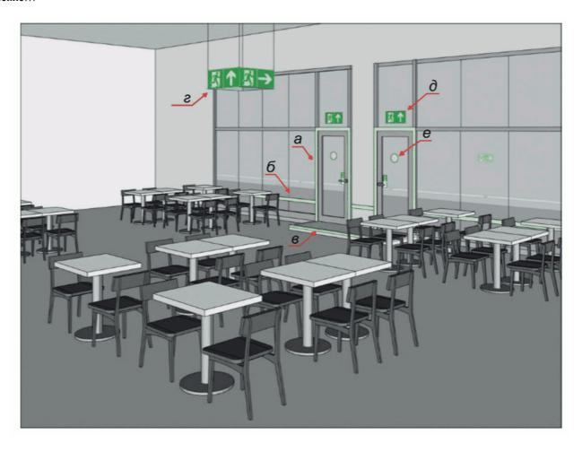
а - обозначение контура и механизма двери; б - обозначение стеклянной перегородки фотолюминесцентной полосой шириной не менее 50 мм; в - обозначение препятствий (ступенек) на полу; г - подвесной указатель направления эвакуации; д - указатель направления эвакуации ("Продолжать движение через эту дверь"), размещенный над выходом; е - обозначение стеклянных дверей фотолюминесцентными элементами круглой формы
