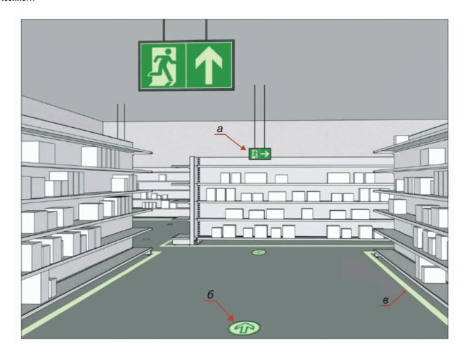
а - потолочный комбинированный указатель направления эвакуации; б - напольный основной указатель направления эвакуации; в - напольная направляющая линия
