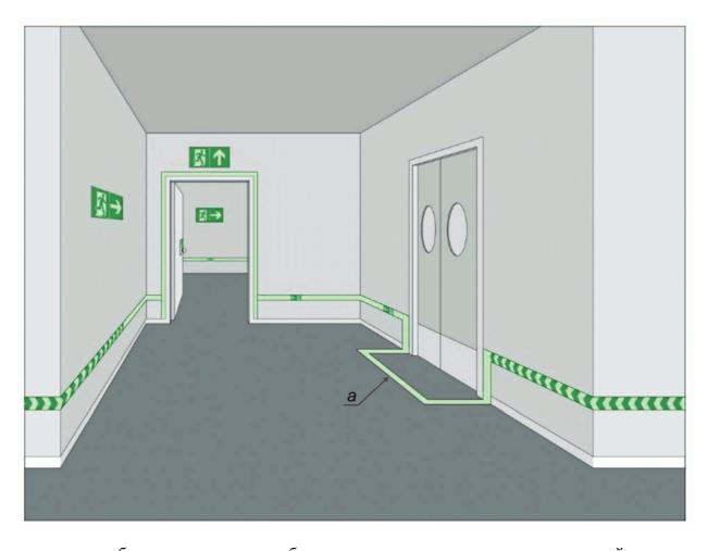
а - обозначение геометрии безопасного эвакуационного пути напольной фотолюминесцентной полосой
