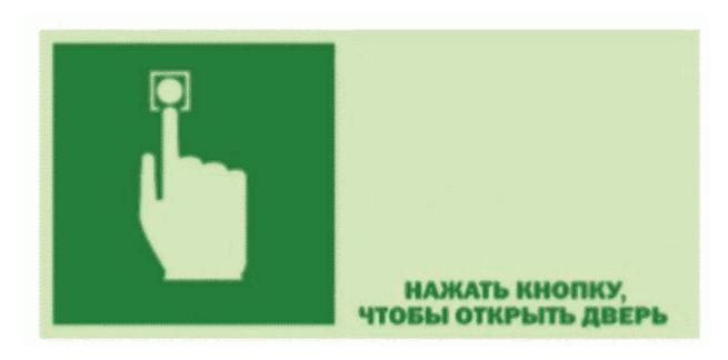
Рисунок 3 - Пример знака для обозначения кнопки экстренного отпирания двери с электронным замком
