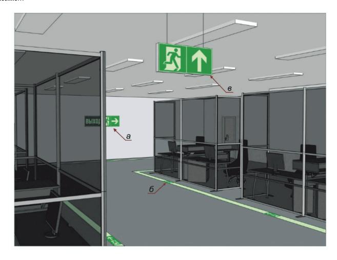
а - настенный комбинированный указатель направления эвакуации; б - напольная направляющая линия с включенным в ее состав указателем направления эвакуации; в - подвесной комбинированный указатель направления эвакуации
