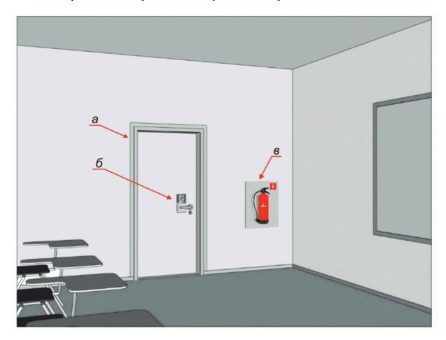
а - обозначение контура двери фотолюминесцентной полосой; б - обозначение механизма двери: в - пример обозначения места размещения огнетушителя при помощи светового экрана
