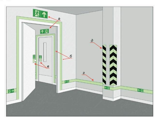
а - указатель направления эвакуации, размещенный над выходом; б - обозначение контура двери фотолюминесцентной полосой шириной 50 мм; в - обозначение механизма двери; г - низко расположенная настенная направляющая линия с включенным в ее состав указателем направления эвакуации; д - обозначение опасной зоны или конструкции здания, которая может стать причиной травмы
