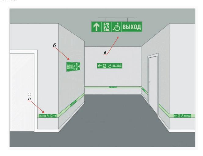
а - низко расположенная настенная направляющая линия с включенным в ее состав указателем направления эвакуации; б - настенный комбинированный указатель направления эвакуации; в - подвесной комбинированный указатель направления эвакуации
