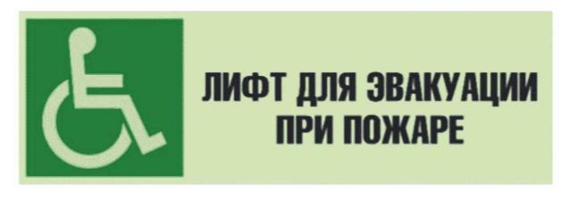
Рисунок 8 - Пример комбинированного знака обозначения лифта для эвакуации инвалидов-колясочников при пожаре
