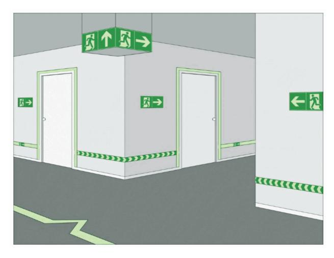
Рисунок В.11 - Пример комбинированного обозначения эвакуационного пути в широких коридорах, проходных помещениях и т.п.
