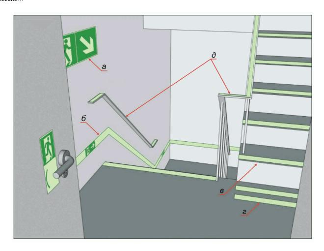
а - комбинированный указатель направления эвакуации; б - обозначение геометрии лестничного марша и площадки при помощи низкорасположенной настенной направляющей линии с включенным в ее состав указателем направления эвакуации; в - обозначение переднего горизонтального края ступеней фотолюминесцентными полосами; г - обозначение окончания лестничного марша двумя параллельными фотолюминесцентными полосами; д - обозначение перил лестницы фотолюминесцентной полосой
