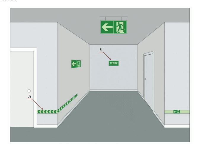
а - низко расположенная направляющая линия со стрелками для дополнительного указания направления эвакуации; б - обозначение тупика
