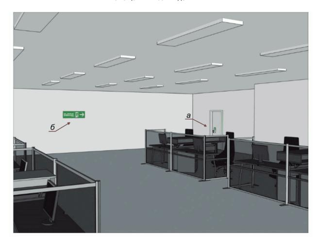
а - обозначение контура и механизма двери; б - указатель направления эвакуации
