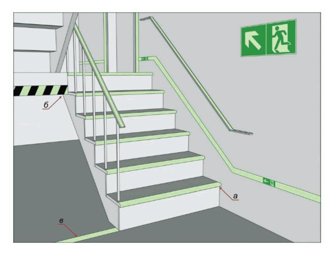
а - обозначение переднего горизонтального и вертикального края ступеней фотолюминесцентными полосами; б - обозначение опасной зоны или конструкции здания, которая может стать причиной травмы; в - обозначение геометрии безопасного эвакуационного пути напольной фотолюминесцентной полосой
