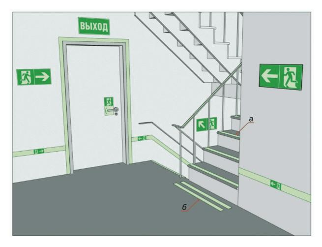
а - обозначение переднего горизонтального края ступеней фотолюминесцентными полосами; б - обозначение окончания лестничного марша двумя параллельными фотолюминесцентными полосами
